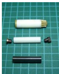
固體NMR用樣品管 體積40-170 \mu l 直接裝入樣品 注意裝樣後的樣品管平衡
